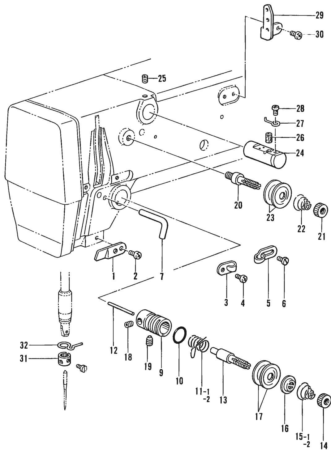
H. 糸通シ関係 / Threading mechanism / Fadenführungs vorrichtung /
