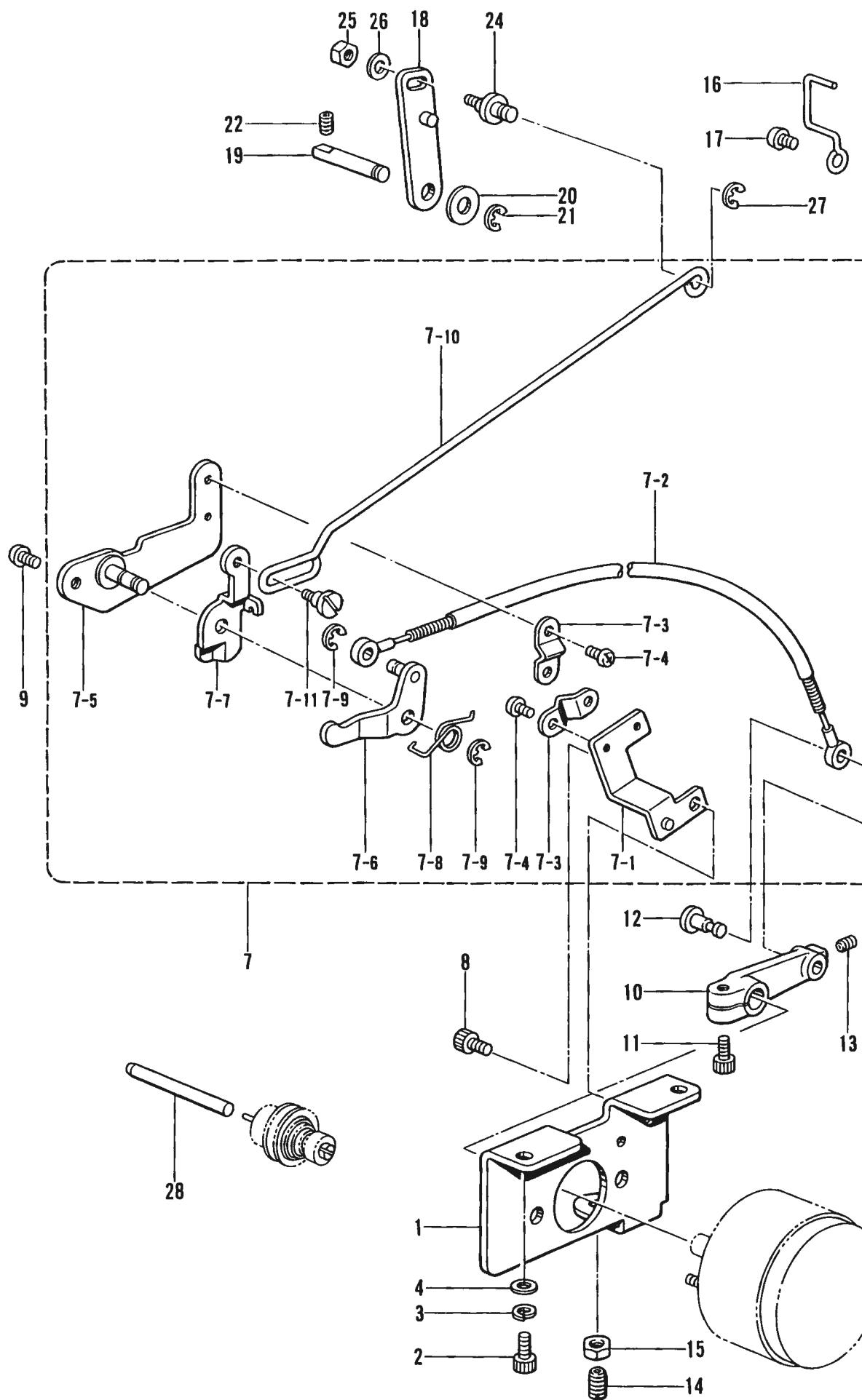
N. 糸締メ関係 / Thread nipper mechanism / Fadenspannvorrichtung /
