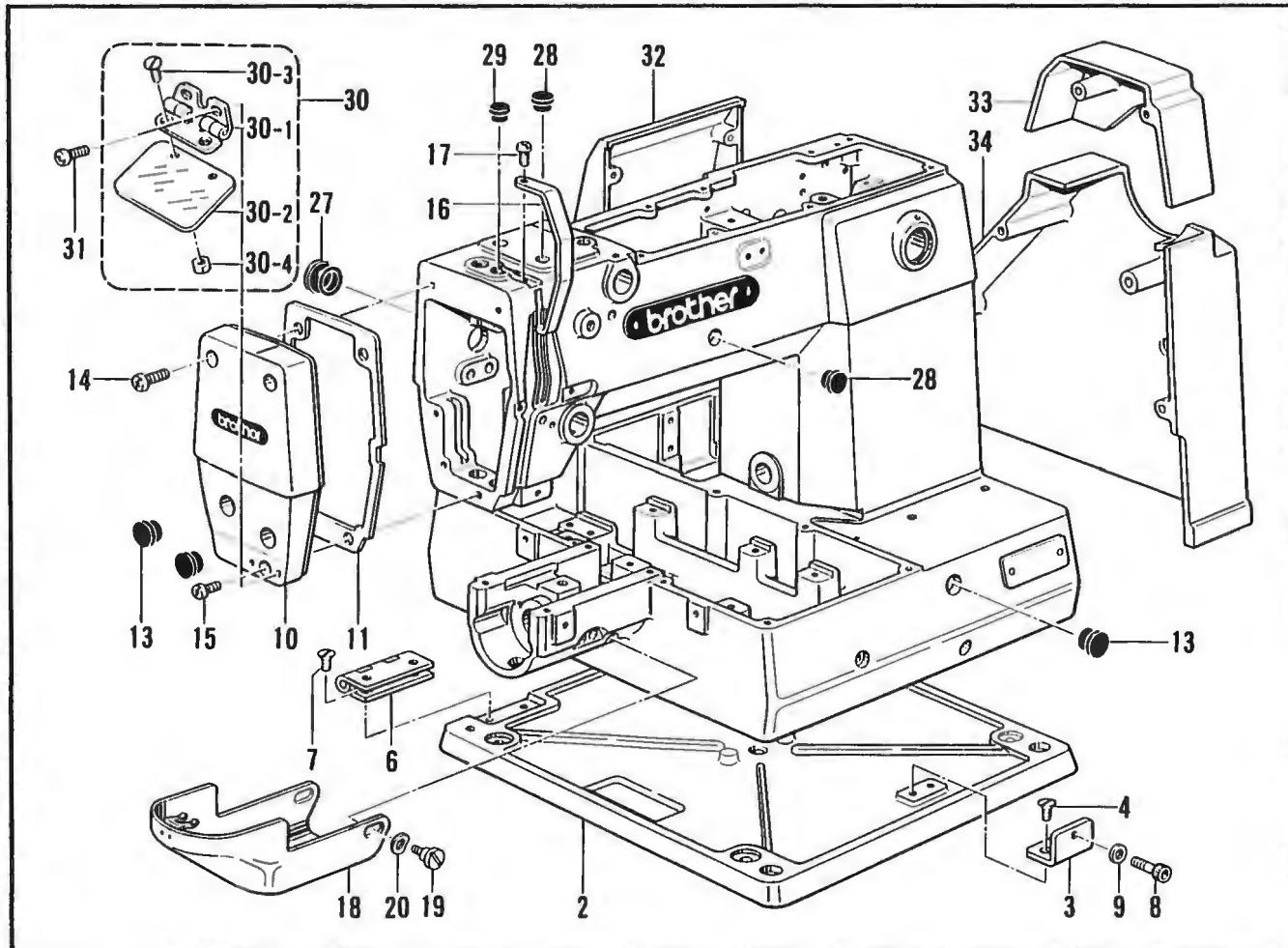
**A2. 主体関係 / Machine body / Maschinengehäuse /
