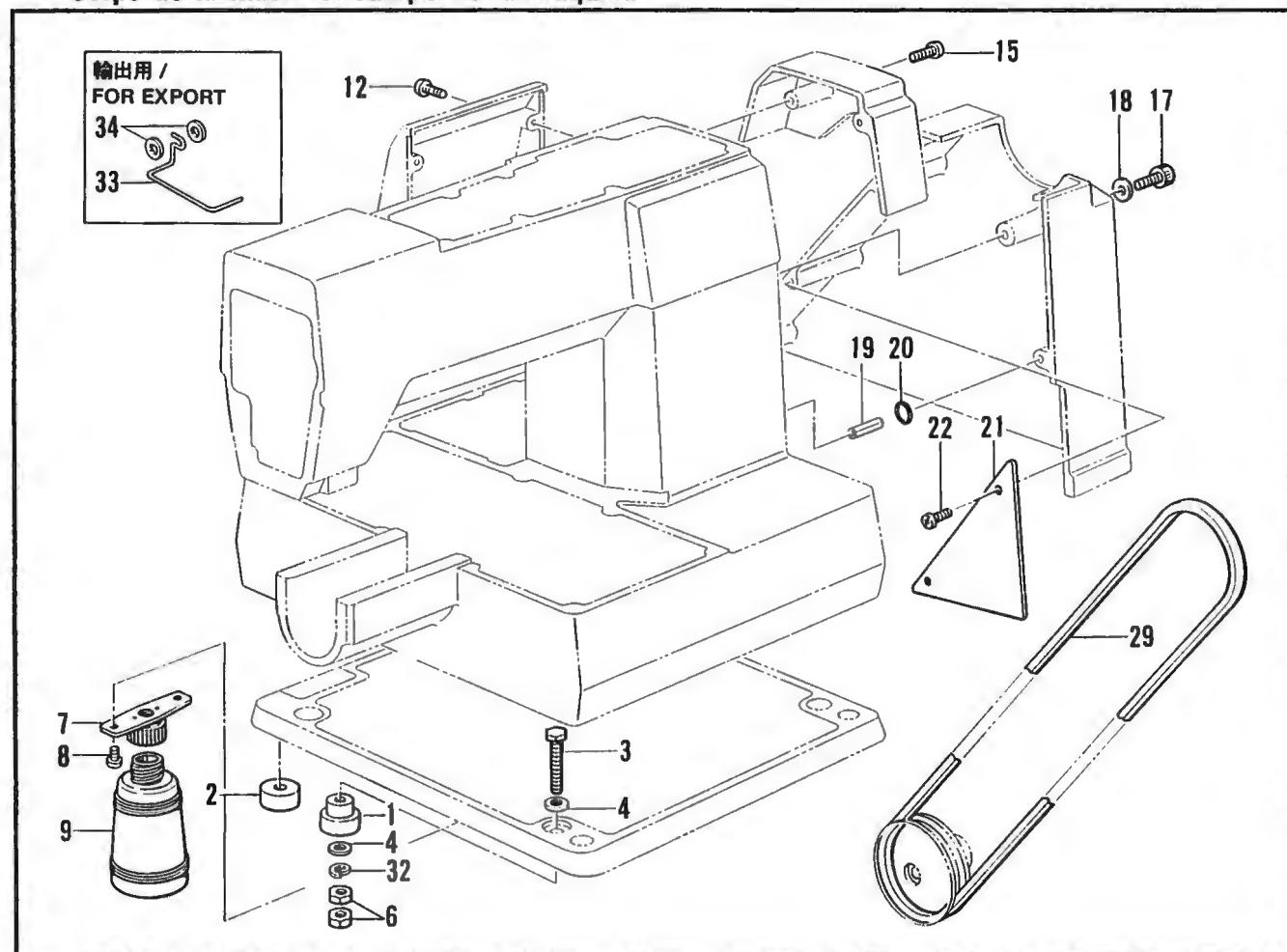
**A1. 主体関係 / Machine body / Maschinengehäuse /
